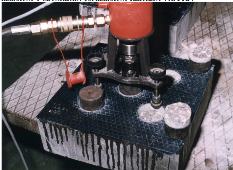
Esecuzione del test secondo UNI EN 1542
