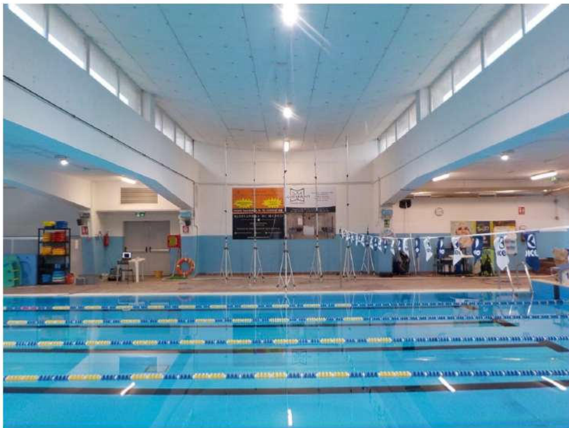
Disposizione dei sensori durante la prova di carico
