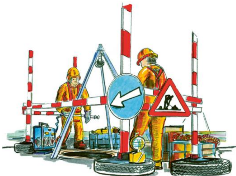
Sbarramento e segnalazione della zona di lavoro
